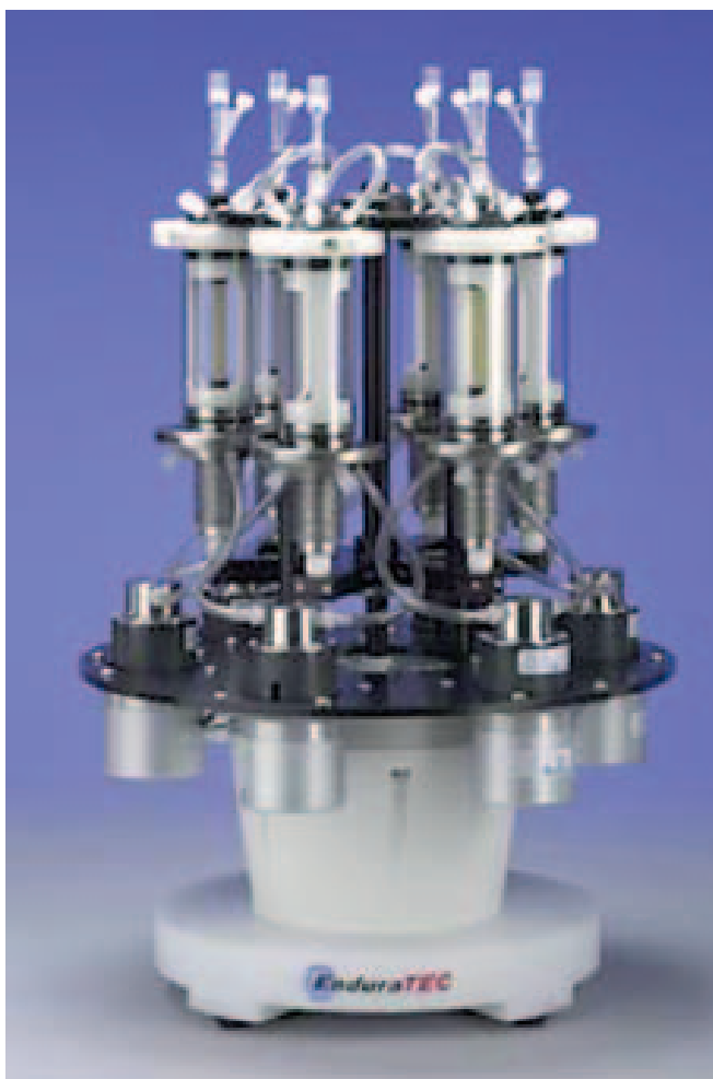
► Fig. 2 BioReactor™ ITEMS, tomado de http://www.enduratec.com . O biorreactor proporciona o ambiente idóneo para que as células poidan colonizar os intersticios do soporte e recrear así un tecido vivo.
